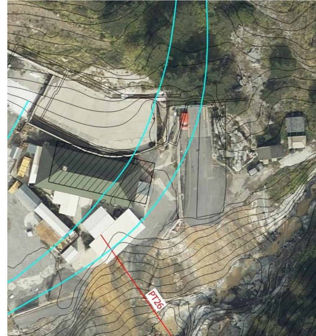
Illustration 129 Piattaforma di accesso alla canna Est - Vista aerea in direzione del limite della carreggiata Per garantire la visibilità all'ingresso del tunnel, per una testata inclinata rispetto all'ammasso roccioso, è necessario alesare nuovamente la testata del tunnel e allargarla.
