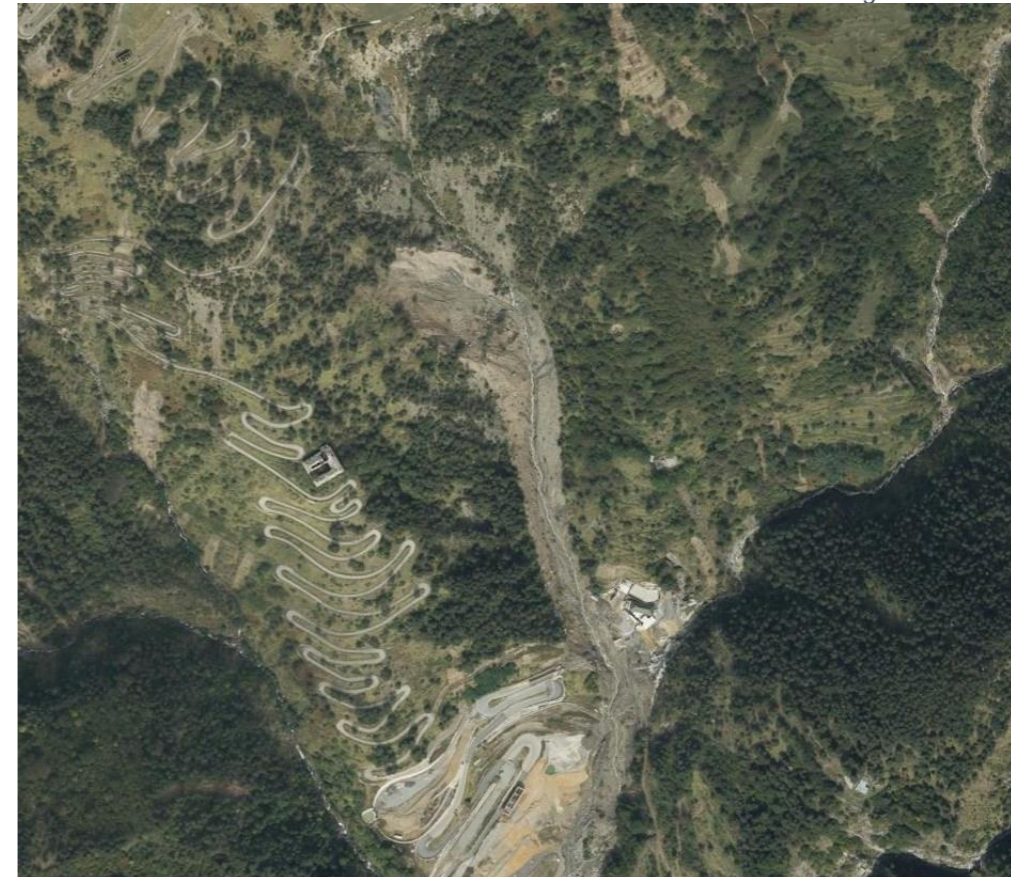
Illustration 2 : Accesso al traforo del colle di Tenda e versante a monte – Ortofotografia "post Alex" – ottobre 2020 (IGN©) Questa illustrazione mostra i movimenti superficiali e profondi del terreno che ora interessano questo versante, nonché il carattere erosivo del Roia.
